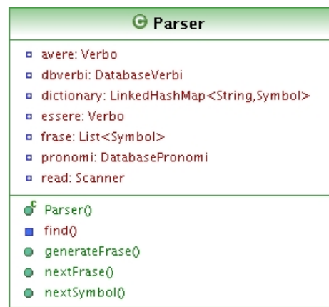
Figura 4.5: Schema UML della classe Parser
