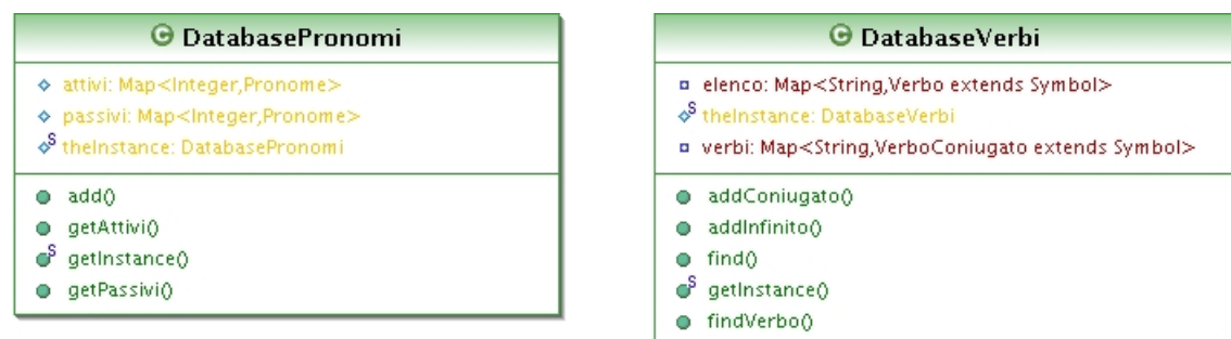
Figura 4.4: Schema UML del pacchetto databases
