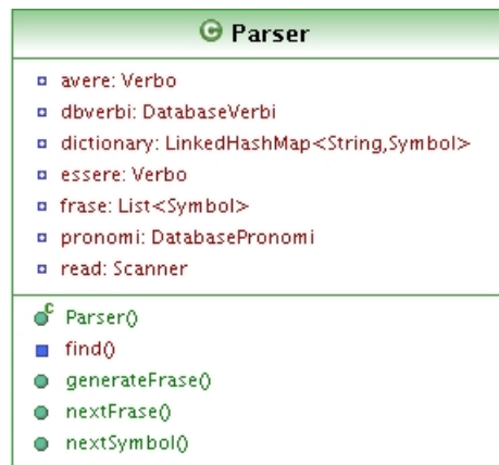
Figura 4.5: Schema UML della classe Parser
