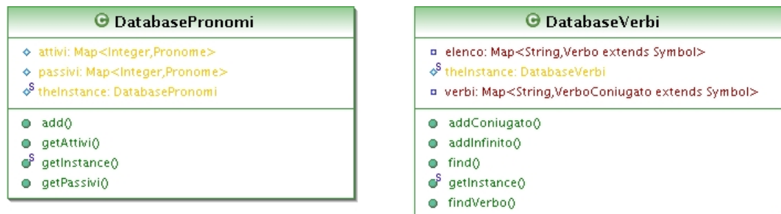
Figura 4.4: Schema UML del pacchetto databases
