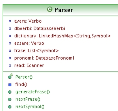
Figura 4.5: Schema UML della classe Parser
