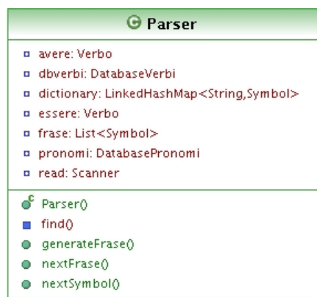
Figura 4.5: Schema UML della classe Parser
