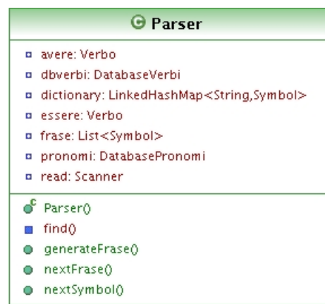
Figura 4.5: Schema UML della classe Parser
