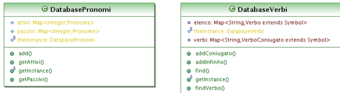
Figura 4.4: Schema UML del pacchetto databases
