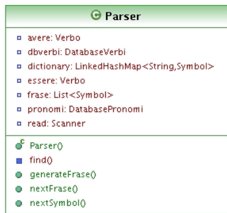
Figura 4.5: Schema UML della classe Parser
