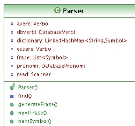
Figura 4.5: Schema UML della classe Parser
