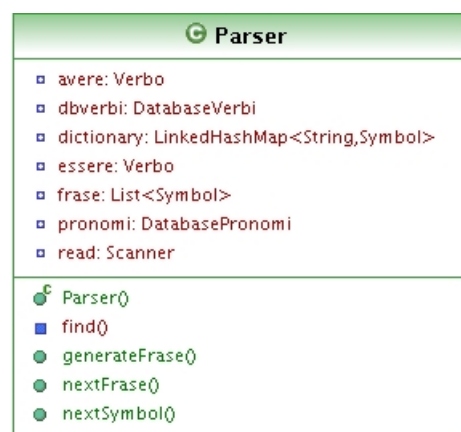
Figura 4.5: Schema UML della classe Parser
