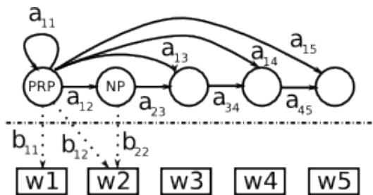
I dati necessari per svolgere i calcoli sono contenuti in due matrici: una,  $A$ , indica le probabilità di transizione tra i tag, l'altra,  $B$ , indica la probabilità che ogni tag corrisponda ad una certa parola. Tali matrici sono calcolabili a partire da un corpus annotato, tramite conteggio.
